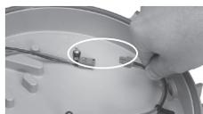
**Déconnexion rapide :** Un simple connecteur à déconnexion rapide permet de couper l'alimentation entre les LED et le module de gestion de la batterie pour faciliter l'entretien.
