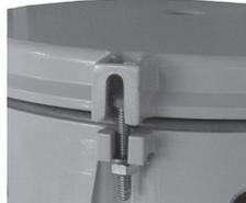
Système de verrouillage et charnière : le système de verrouillage imperdable en acier inoxydable (vis et écrou) se ferme en toute sécurité et résiste aux atmosphères corrosives. La conception escamotable simplifie le câblage et l'installation. Une charnière extra haute offre une protection supplémentaire contre le détachement accidentel du driver à LED lors de l'installation ou de l'entretien.
