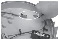
un simple connecteur à déconnexion rapide permet de couper l'alimentation entre les LED et le module de gestion de la batterie pour faciliter l'entretien.
