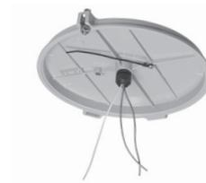
Le capot suspendu étanche assure une protection contre l'infiltration d'eau dans le conduit à l'aide d'un réducteur de tension conforme à l'indice IP68 avec 3 trous de câble de 4 mm (0,157 po) de diamètre.
