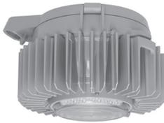
La conception de l'enveloppe du driver à LED comprend des sections séparées pour le bornier et le driver. La conception thermique efficace assure un transfert de chaleur fiable depuis l'ensemble LED vers l'extérieur via le radiateur et l'enveloppe moulée en aluminium avec revêtement en poudre d'époxy.
