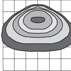
**NEMA 7x6** – Imiter la distribution traditionnelle de la lumière de la lampe à décharge. L'intensité lumineuse est orientée vers l'avant et les côtés afin de maximiser l'espacement entre les luminaires.
