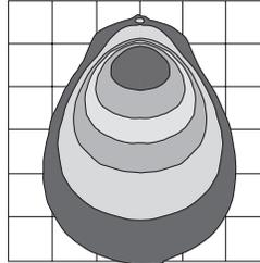
**NEMA 5x5** – Mise au point étroite de l'intensité vers l'avant de type spot. Adapté aux hauteurs de montage plus élevées (15 m/50 pi+) tout en délivrant la quantité de lumière nécessaire au sol (pieds-bougies/lux).
