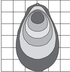
**NEMA 3x3** – Mise au point très étroite de l'intensité vers l'avant de type spot. Adapté aux hauteurs de montage plus élevées (30 m/100 pi+) tout en délivrant la quantité de lumière nécessaire au sol (pieds-bougies/lux).
